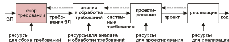
Рис. 1. Процесс сбора требований в ЖЦ
