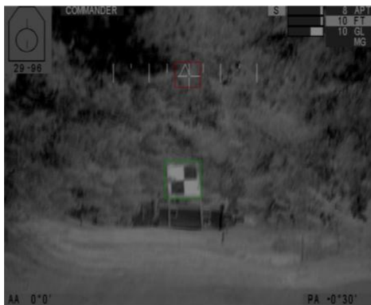
Рис. 1. Приклад поля зору камери прицілу зі щитом-мішенню (зелений прямокутник) та прицільною маркою (червоний прямокутник).
