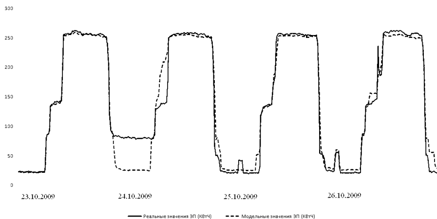
Рис. 3 – График выборки значений потребления электроэнергии в коммерческом здании на осеннем этапе перевода часов
