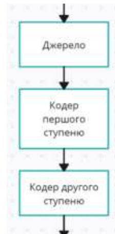
Рис. 4. Загальна схема кодування каскадним кодом
