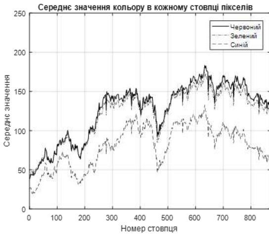
Рис. 2. Розподіл середніх червоного, зеленого та синього кольорів вздовж горизонтальної координати матриці відеокамери
