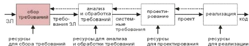
Рис. 1. Процесс сбора требований в ЖЦ
