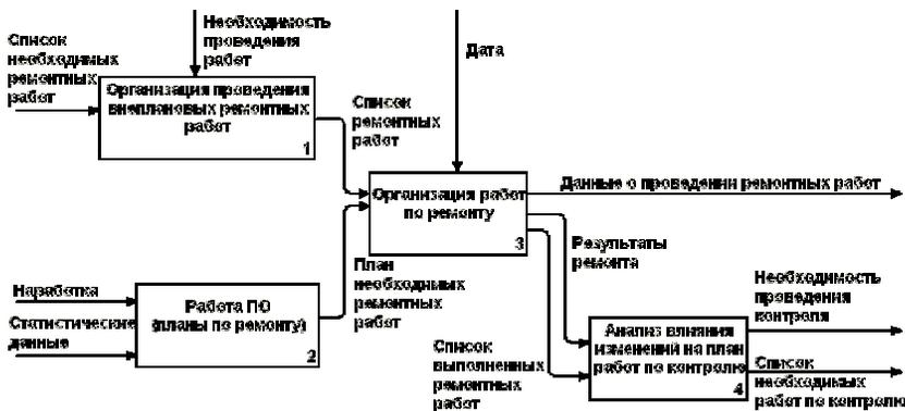
Рис. 2 – Схема процесса «Выполнение работ по ремонту оборудования»
