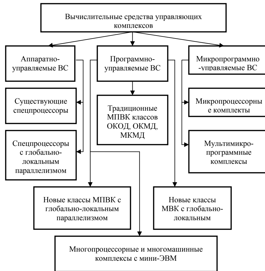
Рис. 2. Классы вычислительных средств управляющих комплексов реального времени
