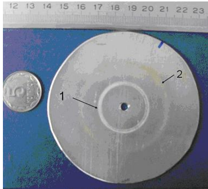
Рис. 2. Отпечатки электронного пучка на алюминиевой мишени. 1 – нарастающее магнитное поле H_{\max} , 2 – спадающее магнитное поле H_{\min}
