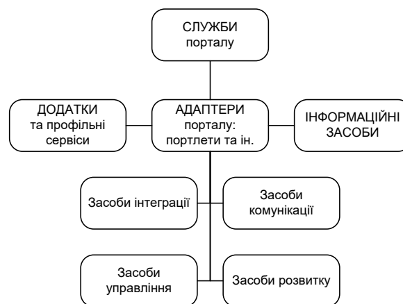
Рис. 1. Структура типового корпоративного інформаційного порталу
